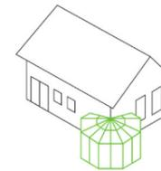
Toit mono-pente avec angle polygonal sur deux côtés
